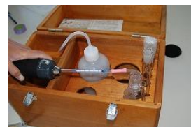
検知管による硫化水素の測定
