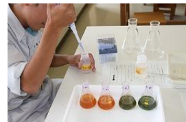
アルカリ性過マンガン酸カリウム-ヨウ素滴定法
