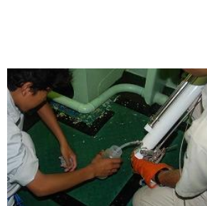
ナンセン転倒採水器による採水
