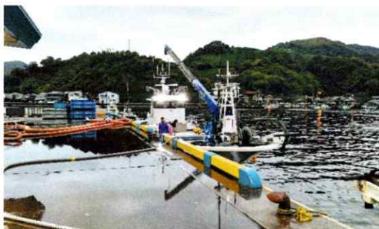
巻き網船の魚槽からホースで魚を吸い出します。
