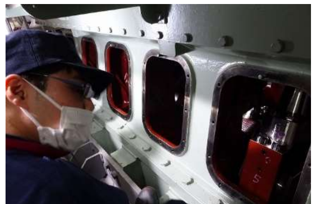
クランクケース開放 クランクデフレクション計測
