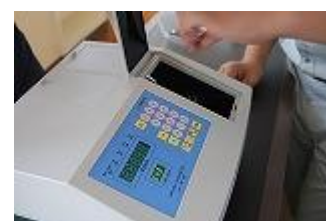
分光光度計によるクロロフィル量の測定
